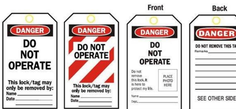
El primer paso antes de comenzar cualquier inspección o trabajo de reparación es cerrar la corriente en la caja de distribución y poner el candado del interruptor en la posición de OFF. Esto aplica aun a los llamados circuitos de bajo voltaje. Rotular seguramente el interruptor o los controles de la máquina o equipo que se esté cerrando del servicio aclara a todos en el área qué equipo o circuitos están siendo inspeccionados o reparados.
